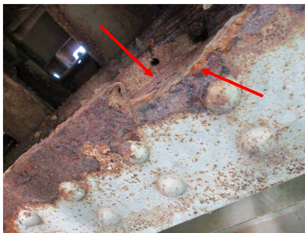
Дубинска корозија доње фланше и губитак попречног пресека носача 3 у пољу 0-1
