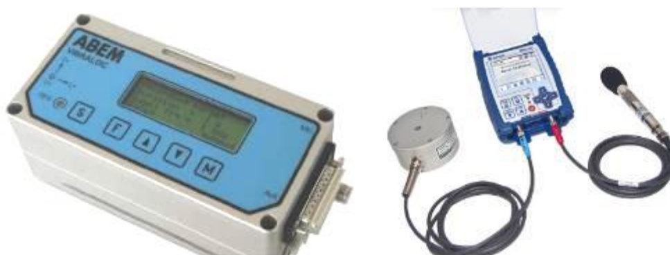
Слика 23. Приказ инструмента ABEM VIBRALOC i INSTANTEL MICROMATE
