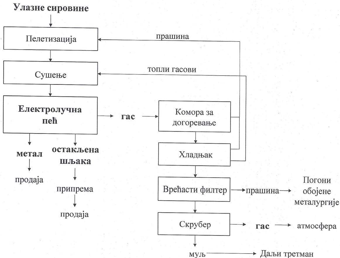
Сл. 3.2 Блок технолошка шема процеса у оквиру линије остакљивања опасног отпада у електролучној пећи
