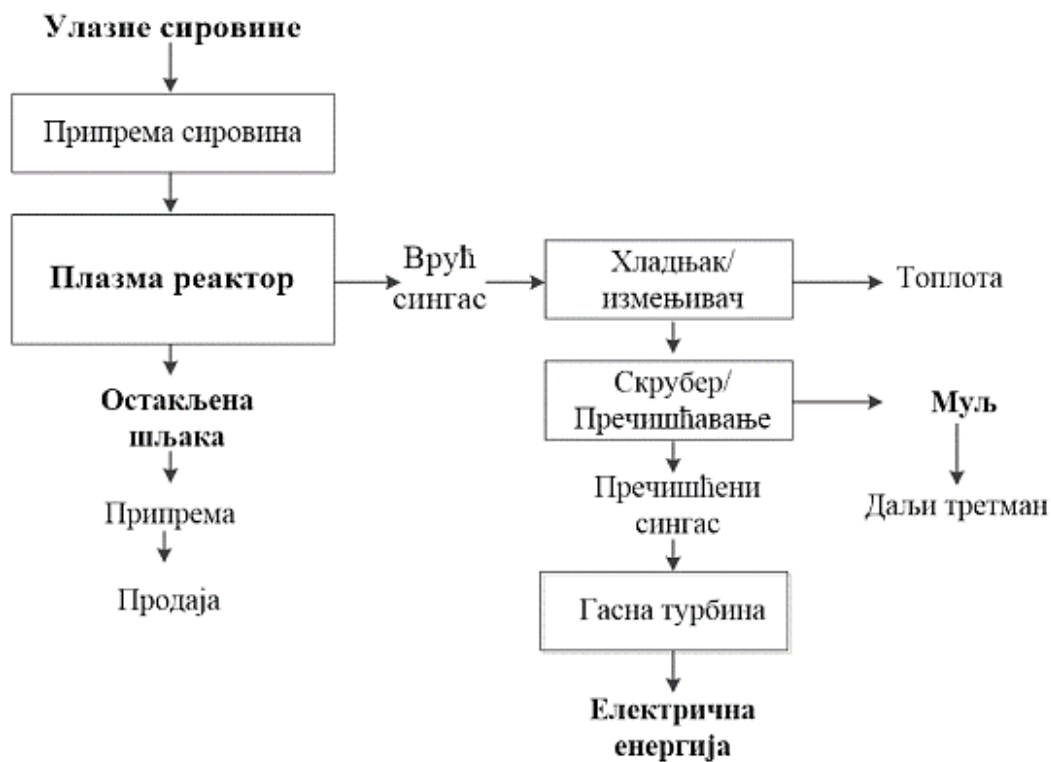
Слика 10. – Блок технолошка шема процеса у оквиру линије за гасификацију
