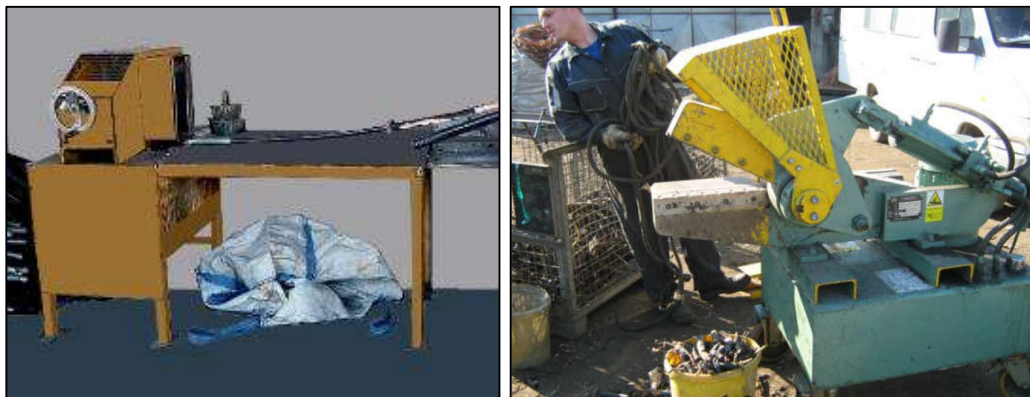
Слика 29. – Изглед стрипера (лево) и механичке маказе за скраћивање каблова (десно)
