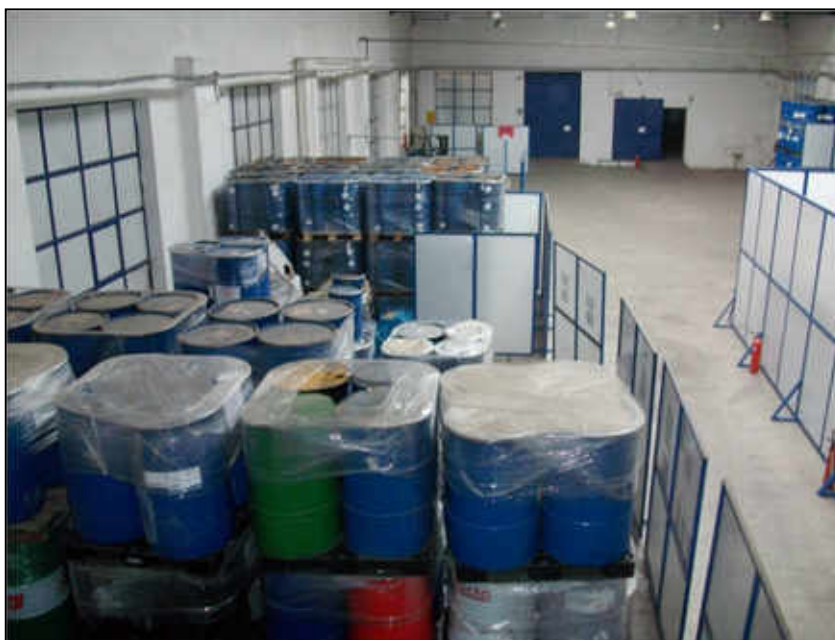
Slika 3.6 Uskladišten otpad unutar podnog skladišta opasnog otpada
