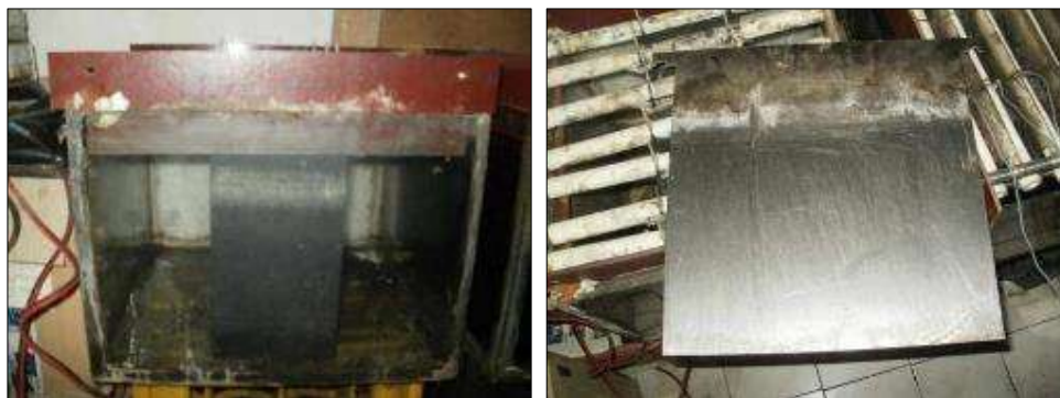
Слика 30. – Сабирна посуда за електролизу (лево) и прохромска електрода – анода (десно)
