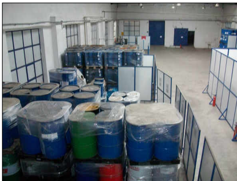
Slika 2.2 Pastozni otpad sa tečnim sadržajem propisno upakovan i uskladišten
